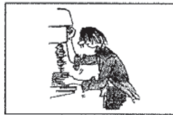
مسك القطعة باليد أثناء عملية الثقب
